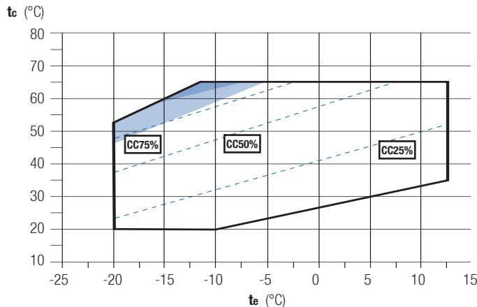
**R134a** motore - motor - motor 2
