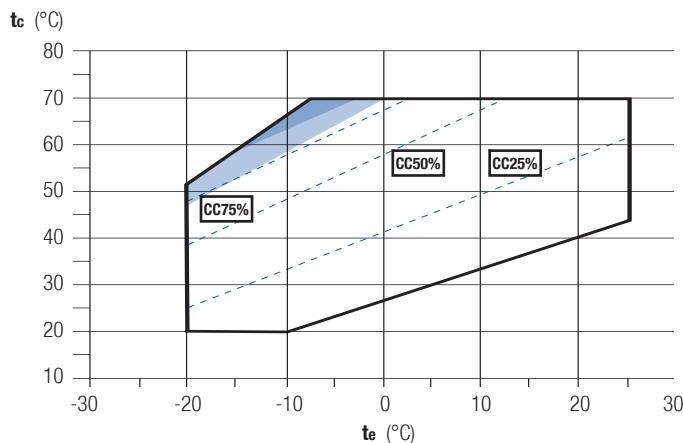
**R404A** motore - motor - motor 2
